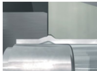
Внутренний контур также слегка деформируется, но остается ровным и не препятствует потоку
