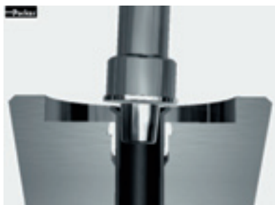
Когда плоская рабочая поверхность штифта коснется конца трубы, начинается процесс развальцовки
