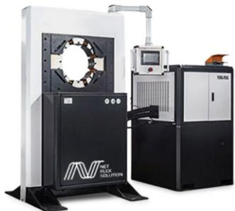
Обжимной станок NFP 10 Eco Kit дополнит ваши производственные мощности станком для рукавов больших и сверхбольших диаметров.
