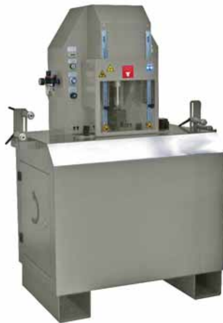
TH 3E-115 Отрезной станок для рукавов
