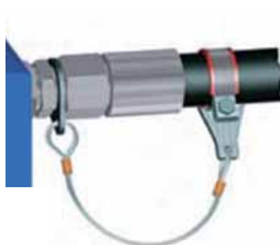
Ограничитель для рукавов, присоединяемых с помощью адаптеров
